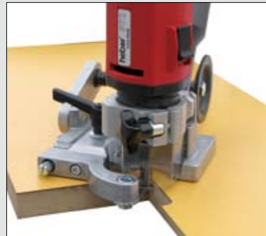
Fräsen von Innenecken mit Bogenanschlag
