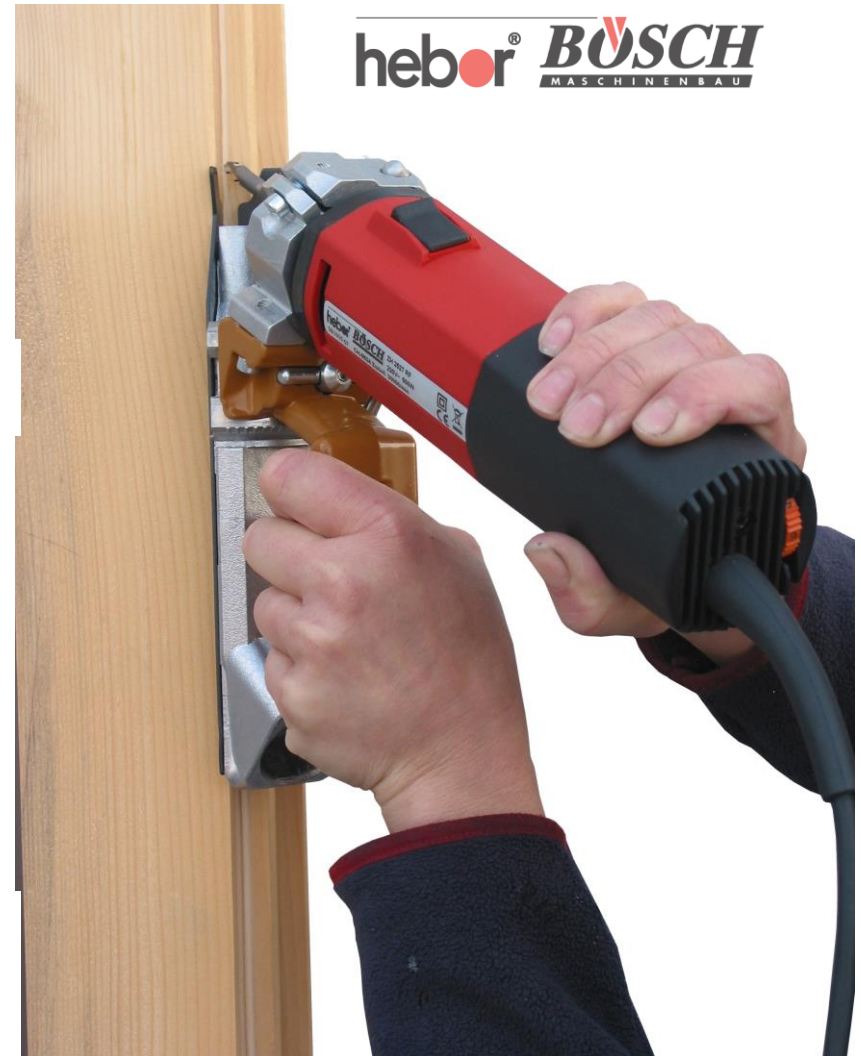
45° Fräsung mit Hohlkehle bei kleiner Fensterluft
