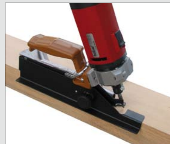
Winkelfräsung Flachfräsung Winkelfräsung mit Hohlkehlung (durch tiefere Frasereinstellung) Flachfräsung mit Hohlkehlung Fraisage d'angle Fraisage à plat Fraisage d'angle avec quart de rond (régler la fraise plus profondément) Fraisage à plat avec quart de rond
